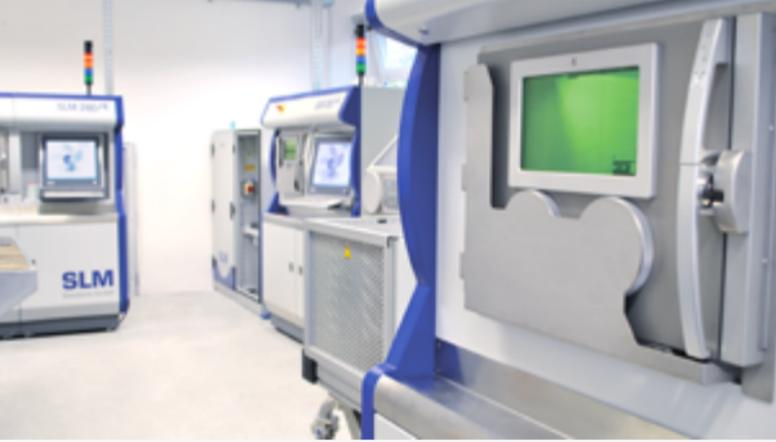
Unsere additive Fertigung basiert auf der SLM-Technik - **Selective Laser Melting** (selektives Laserschmelzen). Es gehört zu der Gruppe der Strahlschmelzverfahren und wird auch häufig als 3D-Drucken von Metallen bezeichnet.
